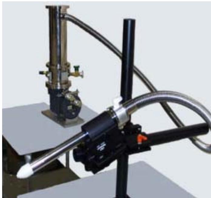
ノズル先端にヒータを付け、ガス出口での空気の凍結を防ぎます。
