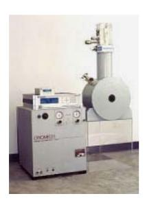
左の写真は世界で最初のパルスチュ - ブ冷凍機型 クライオフリ - マグネットシステムです。
