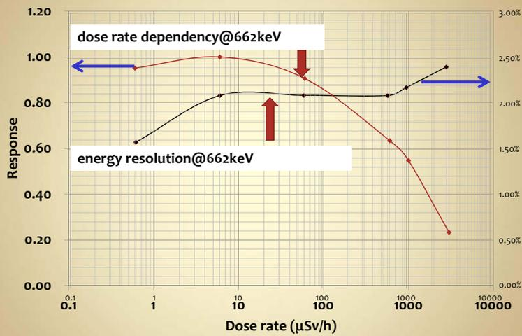
エネルギー分解能の変化に比し、パイルアップの影響で光電ピークの計数率直線性は線量率に大きく依存する
