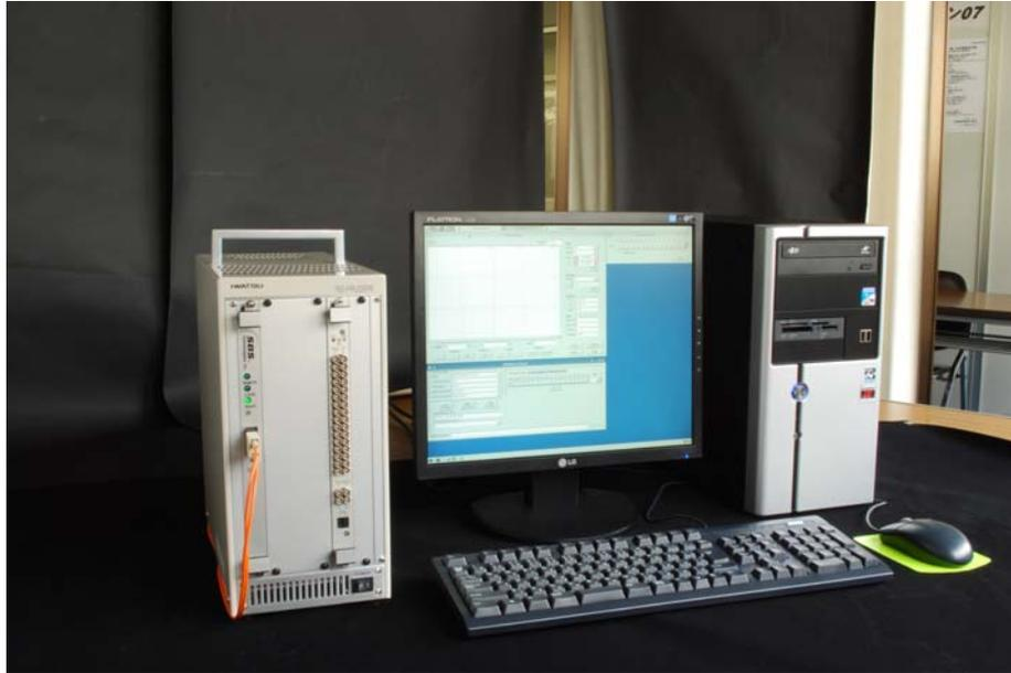
3000-E シリーズは A3100(16input PHA+LIST モジュール) を制御するための基本制御システムです。
